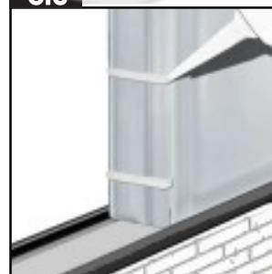
Aplique una línea de silicona en el lateral del bloque y luego pegue la separación vertical al bloque aplicando silicona en la parte exterior del bloque.
