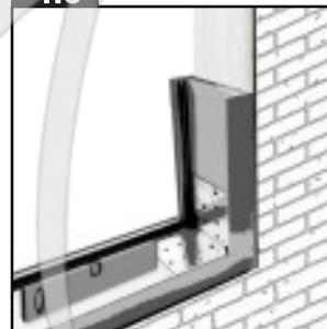
Asegurarse de que el perfil de la parte inferior y los dos laterales estén nivelados.
