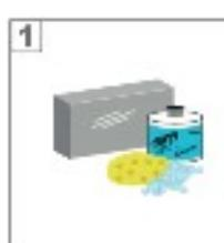
Limpiar los bloques macizos de vidrio Crystal Block antes de la instalación. No es necesaria la limpieza de ladrillos de vidrio satinado.
