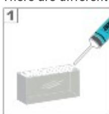
**1** El adhesivo es aplicado al bloque haciendo líneas en zigzag (aprox. 2-3 mm de ancho). Atención: se pueden formar burbujas en el adhesivo.
