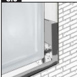
Coloque el primer bloque de vidrio en un extremo, sin silicona, en el perfil horizontal y vertical de la primera fila.
