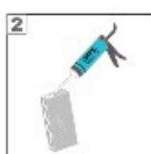
Aplicar el adhesivo en un lado largo y otro corto siguiendo la técnica seleccionada. El bloque debe estar unido en 7 minutos para evitar el secado del adhesivo.
