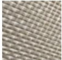
Espesor reducido a 3+ mm con mechas tejidas\*, puede garantizar más ligereza y seguridad al mismo tiempo para su manipulación y colocación, con un aumento sustancial de la resistencia mecánica.
