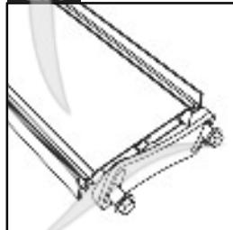
Fijar los enganches "A-80" a las extremidades de los perfiles horizontales "CH-80/.." con los tornillos que dotamos. Aflojar los tornillos tres cuartos de vuelta, y regularlo en base a la sujeción.
